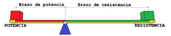
Estamos rodeados de palancas y vamos a poder identificarlas según su grado (tipo de palanca en función de dónde se aplica cada fuerza y la posición del fulcro).
